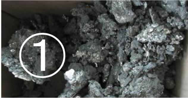
半田ドロスは、お客様のドロス回収処理方法により大きく分かります。この写真はあるお客様の保管ドロスの再生依頼を頂いたときの写真ですが、保管されていたドロスは、塊から細かな破片まで混在してました。現在私共のドロス再生装置は、以下の写真からし見ますと③の赤い円囲んだレベルのドロスを再生する装置と成っております。塊の場合は、半田熔融タンクで再溶解して、ドロスのみを取り出す事に成ります
